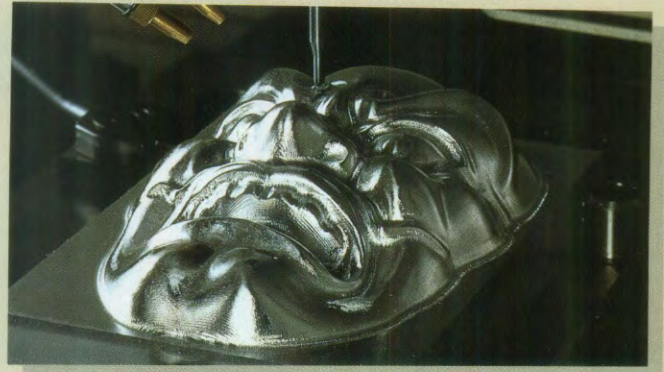
微小線分が連続するブロックを高速加工 High-speed machining of consecutive short lines
