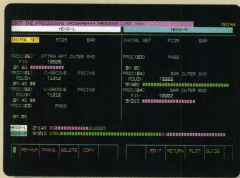
2系統旋盤のスケジュール画面 Scheduling screen of a 2-path lathe
